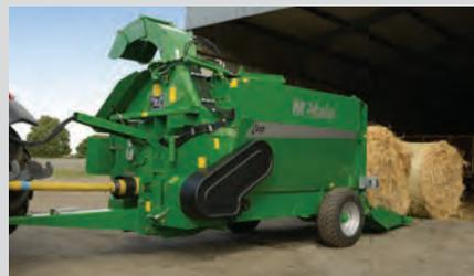
Le hayon arrière permet de charger une balle sans recourir à un deuxième tracteur, limitant la main d'œuvre nécessaire et maximisant la sécurité de l'opérateur. La forme courbée de la porte permet de facilement maintenir une balle lorsque l'opérateur retire les ficelles ou le filet de celle-ci.
