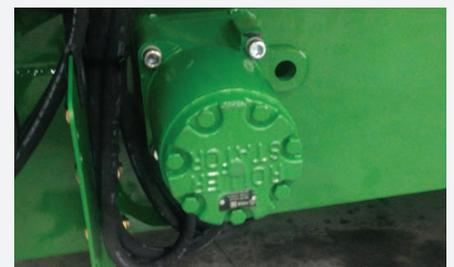
L'entraînement du tapis est indépendant de celui du rotor. Le sens d'avancement du tapis peut être ainsi inversé sans que le rotor ne soit stoppé.
