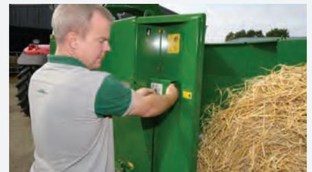
Pour éviter des accidents lors de la manipulation des balles, un bouton de sécurité est situé sur le côté du boîtier de commande extérieure du hayon. Ce bouton doit être pressé en même temps que les autres pour pouvoir commander les fonctions désirées.
