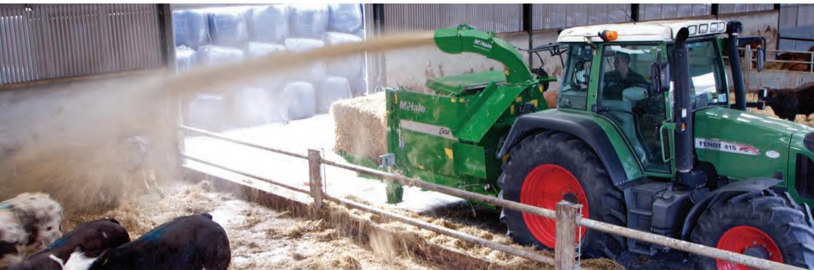
Les machines de la gamme C4 sont équipées d'une goulotte en trois modules. Ces trois modules minimisent la résistance et permettent d'atteindre une distance de projection maximale, spécialement dans les endroits exigus.
