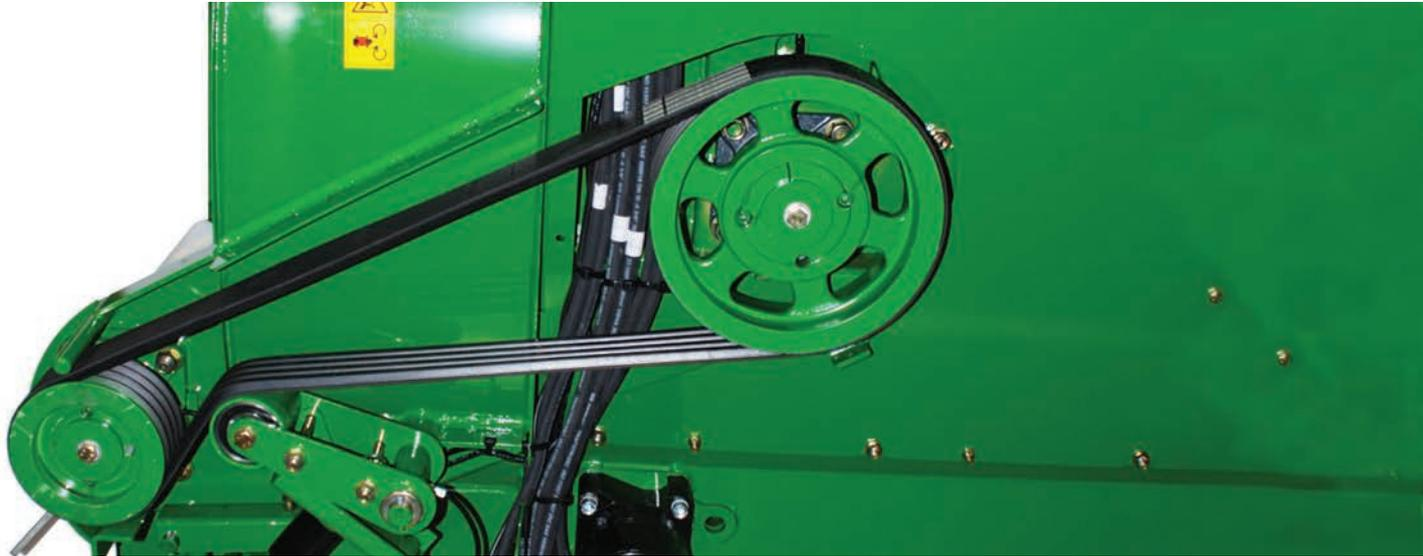
La courroie à couple élevé qui entraîne le rotor d'alimentation peut être activée ou désactivée via l'hydraulique du tracteur. Ce système permet de faire travailler la turbine indépendamment du rotor.
