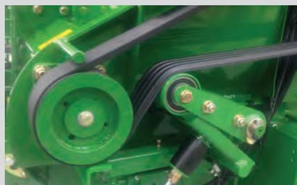
Les machines de la gamme C4 sont conçues pour que le rotor travaille indépendamment de la turbine. Ceci permet à la turbine d'être à sa vitesse maximale avant que le fourrage ne soit envoyé dans le rotor.
