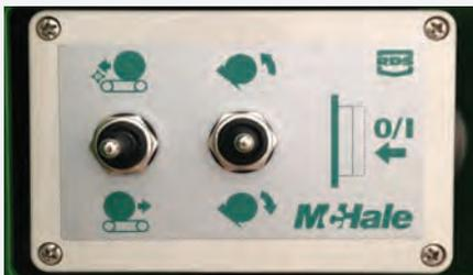
La commande du hayon est disponible de série à l'arrière de la machine. L'opérateur peut facilement commander les mouvements de la porte sans avoir à remonter dans le tracteur. Le hayon et le tapis sont alignés de manière à assurer un chargement aisé des balles carrées et offrent ainsi une grande polyvalence.
