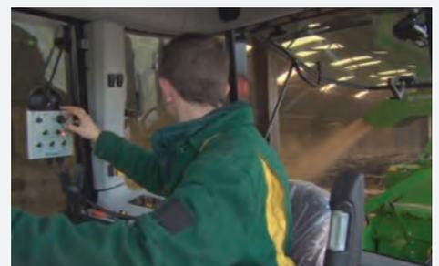
La goulotte est commandée par un joystick, l'utilisateur peut ainsi régler la hauteur et la direction depuis le boîtier de contrôle. La rotation à 300° de la goulotte permet d'envoyer du fourrage à gauche, à droite et même derrière la machine. La goulotte peut aussi être abaissée afin de facilement distribuer du fourrage dans des auges.
